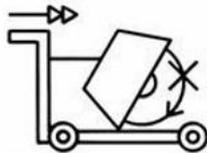
Jedes Umsetzen der Maschine außerhalb des Bereichs, in dem Schneidarbeiten durchgeführt werden, muss mit nicht rotierendem Werkzeug durchgeführt werden.
