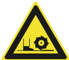
Halten Sie Hände, Füße und lose Kleidungen von beweglichen oder rotierenden Geräteteilen fern. Berühren Sie niemals eine rotierende Trennscheibe mit der Hand oder einem anderen Körperteil. Schwere Verletzungsgefahr!
