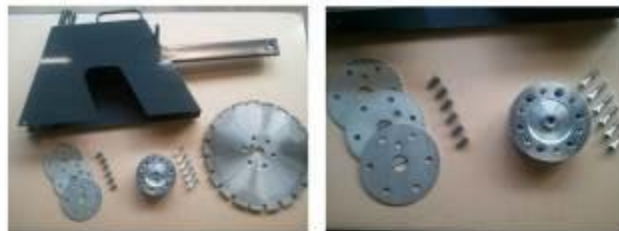
Einzelteile: Wandbündighaube - Wandbündigflansch - 3 Stk. Unterlegscheiben 1x3 mm + 2x2 mm-8 5tk Maschinenschrauben Inbus M8x35 mm-6 Stk. Senkschrauben M8x20 mm
