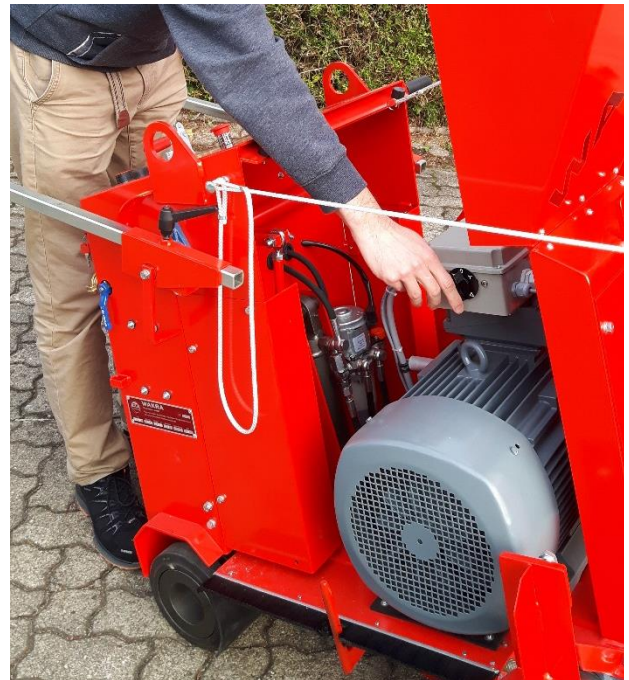
Darstellung des Hauptschalters und die richtige Arbeitsposition um diesen zu bedienen
